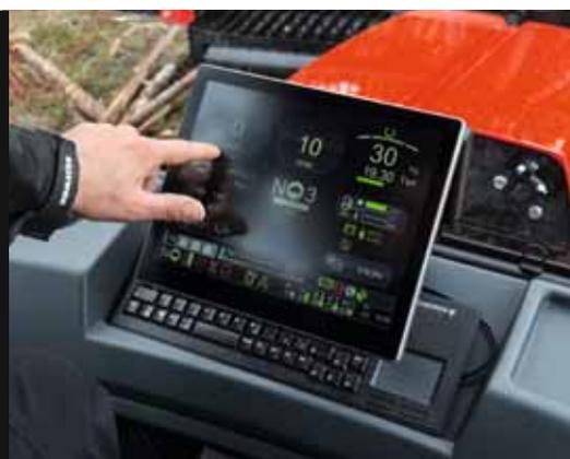
Система управления MaxiXplorer вооружает оператора всем необходимым, от точного и эффективного управления машиной до программы контроля эксплуатации и выработки продукции, одной из лучших среди предлагаемых на рынке.
