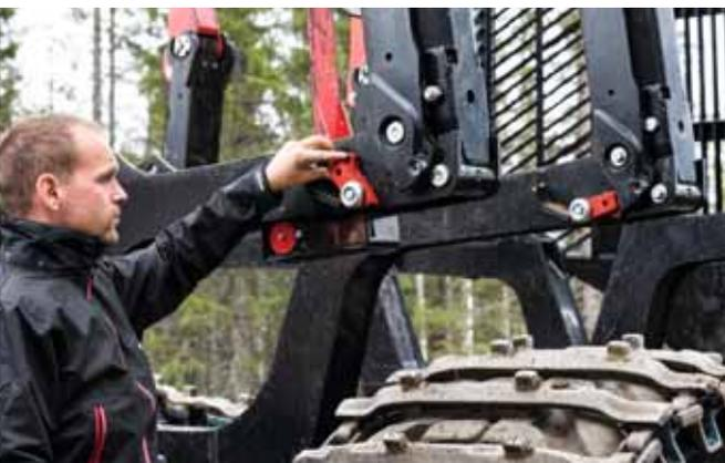
Благодаря FlexBunk внутренние размеры грузового отсека можно варьировать по ширине и высоте, не выходя из кабины.
